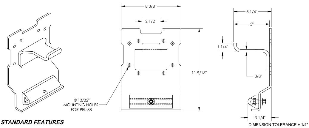
MODEL NUMBER IS PEL-400S-KEG-KT **OVERALL WIDTH IS 83/8"** USABLE WIDTH IS 2 1/2" OVERALL LENGTH IS 5 1/4" USABLE LENGTH IS 5" OVERALL HEIGHT IS 11 9/16" LIP HEIGHT IS 1 1/4" MAX CAPACITY IS 400 lbs TOUGH BAKED IN POWDER COATED YELLOW FINISH
