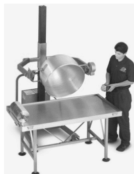
Pour cooked contents of kettle onto cooling table
