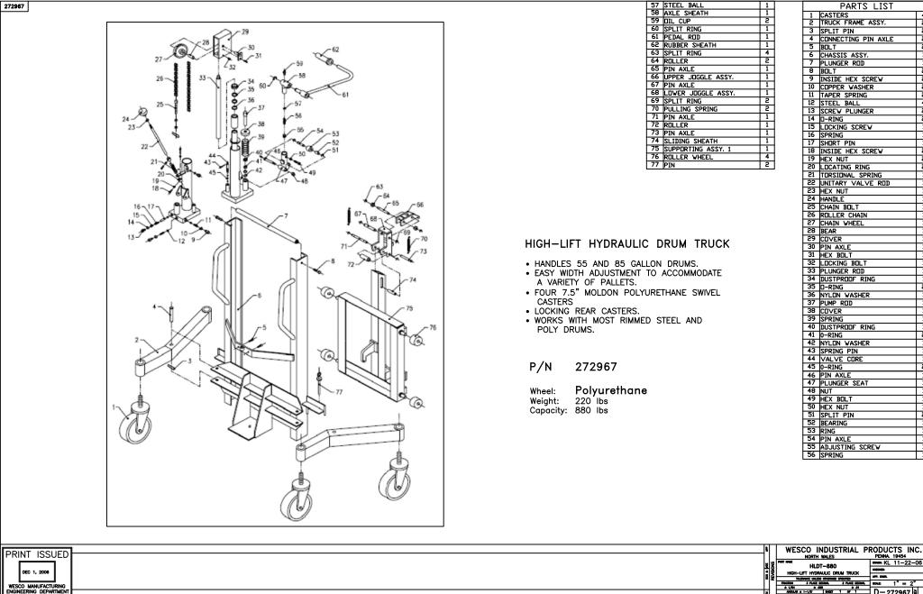
2 2 4 2 2 1 1 2 2 2 1 10 COPPER WASHER 11 TAPER SPRING 12 STEEL BALL 13 SCREW PLUNGER 15 LOCKING SCREW 18 INSIDE HEX SCREW 20 LOCATING RING 21 TORSIONAL SPRING 1 22 UNITARY VALVE ROD 1 1 1 1 1 1 1 1 1 1 1 2 26 ROLLER CHAIN 27 CHAIN WHEEL 32 LOCKING BOLT 33 PLUNGER ROD 34 DUSTPROOF RING 36 NYLON WASHER 1 1 40 DUSTPROOF RING 1 1 1 2 42 NYLON WASHER 44 VALVE CORE 1 1 1 1 2 1 1 1 47 PLUNGER SEAT 55 ADJUSTING SCREW 1
