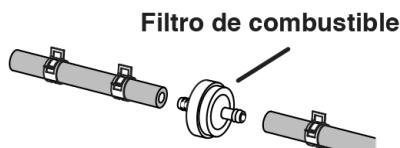
3. Tenga en cuenta la orientación del filtro de combustible. Con unos alicates, retire las abrazaderas de la línea de combustible y retire el filtro de combustible.
