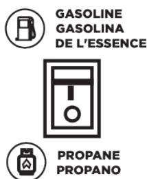
Empuje el selector de combustible completamente hacia arriba para operar con gasolina.
