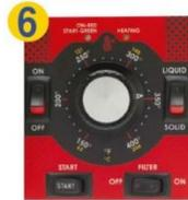
6 Une fois le bac vide, appuyez sur l'interrupteur **FILTER** pour fermer le moteur/pompe.
