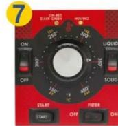
7 Une fois le niveau d'huile vérifié et contrôlé, appuyez sur l'interrupteur **START** (démarrer). Le voyant rouge passe alors au vert. Les brûleurs ou les éléments chauffants se rallument alors automatiquement et la friteuse chauffe à nouveau. Le voyant ambré s'allume alors.
