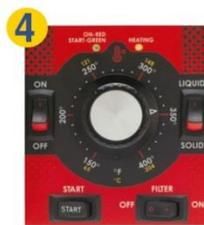
**4** Appuyez sur l'interrupteur **START** pour initialiser le chauffage. Les brûleurs ou les éléments chauffants s'éteindront et se rallumeront en alternance durant le cycle de fusion. À 135 °F, le brûleur ou l'élément chauffant reste allumé jusqu'à ce que la température programmée soit atteinte. Le voyant indicateur passe alors du rouge au vert. Lorsqu'il y a appel de chaleur, le voyant ambré s'allume.
