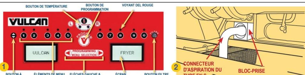
**1** Ouvrez les portes de la friteuse et assurez-vous que le tiroir-filtre est bien en place sous la friteuse et que le connecteur d'aspiration du tube en S et le bloc-prise sont enclenchés. L'interrupteur de filtre se trouvant derrière la porte doit être en position FILTER (et non sur Hose, ou boyau).
