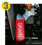
3 Ouvrez lentement le robinet de vidange pour laisser l'huile s'écouler dans le bac de filtration. Les brûleurs ou éléments chauffants s'éteignent alors automatiquement.
