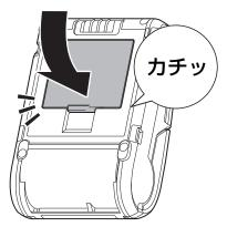
バッテリーのフックの位置を確認して、セットできていることを確認してください。確実にセットできていないと、バッテリーが外れ、けがや機器の損傷の原因となります。
