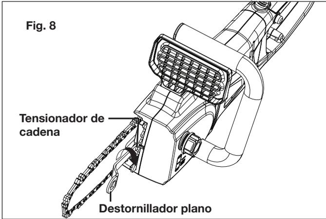
8. Vuelva a colocar la cubierta de extremo de cadena/piñón. Apriete la tuerca de cubierta de extremo, pero deje la barra con libre movimiento para el ajuste de tensión.
