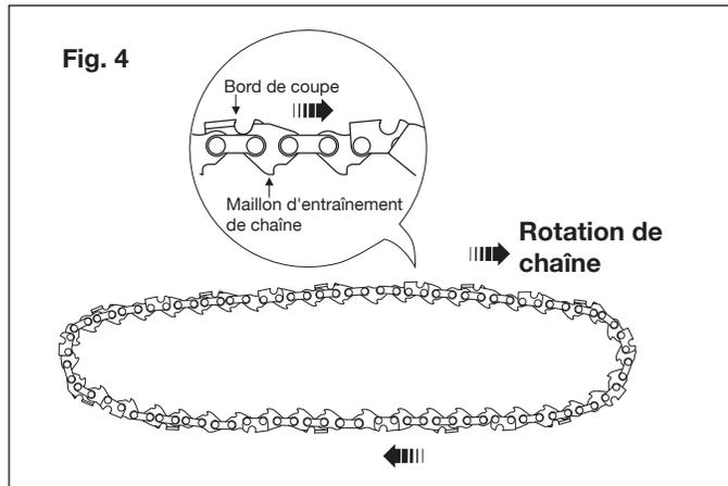
5. En commençant par l'extrémité, montez les maillons d'entraînement de la chaîne dans la rainure du guide en formant une boucle à l'arrière du guide. La chaîne s'ajustera en restant lâche jusqu'à ce qu'elle soit placée sur le pignon (Fig. 5 et 6).
