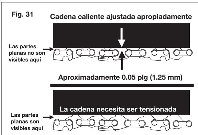
**NOTA:** una cadena nueva tiende a estirarse. Compruebe la tensión de cadena y re-tensione según se necesite.
