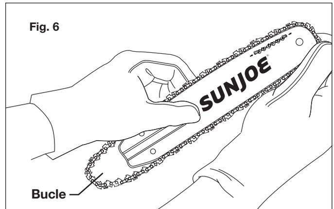
6. Sostenga la cadena en su lugar sobre la barra y coloque el bucle alrededor del piñón. Coloque la barra nivelada contra la superficie de montaje, de manera que los pernos de la barra estén en la ranura larga de la barra y la clavija de ajuste esté en el orificio de clavija de tensión de cadena (Fig. 7).
