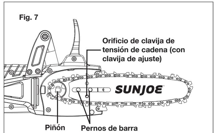
7. Ajuste la tensión de cadena según se necesite girando el tornillo tensionador de cadena con el destornillador de punta plana suministrado. Asegúrese de alinear el tornillo tensionador de cadena con el orificio de clavija (Fig. 8).
