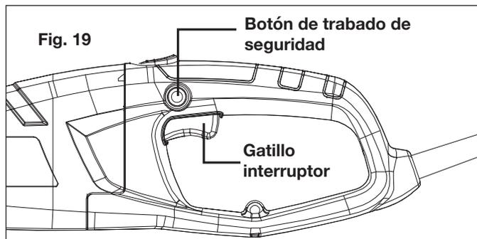
5. Para apagar la herramienta, suelte el gatillo interruptor (Fig. 16).
