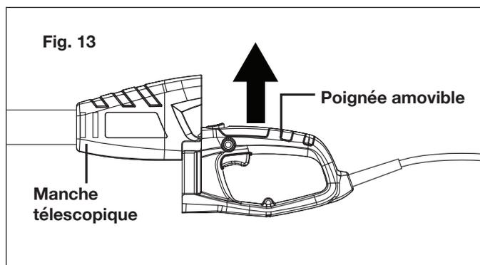
**⚠ AVERTISSEMENT!** Avant d'utiliser la scie à chaîne à manche télescopique, toujours s'assurer que la tête de coupe et le verrou de poignée sont tous les deux attachés ensemble et verrouillés.
