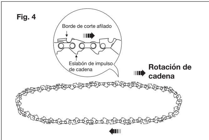
5. Empezando en la punta, monte los eslabones de impulso de la cadena en la ranura de la barra, dejando un bucle en la parte posterior de la barra. La cadena encajará suelta hasta que sea colocada alrededor del piñón (Figs. 5 y 6).
