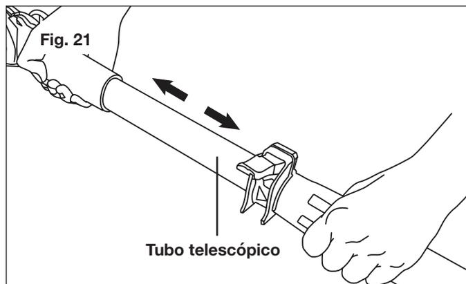
4. Trabe el tubo en su lugar cerrando el seguro de leva (Fig. 22), y compruebe que el tubo esté seguro. Si el tubo se extiende cuando el seguro de leva está cerrado, la tuerca puede necesitar ser apretada.
