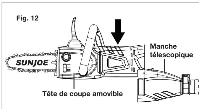
4. Raccordez la poignée amovible et le manche télescopique en alignant leurs extrémités ensemble et en faisant glisser la poignée amovible vers le haut jusqu'à ce qu'elle se mette en place en s'enclenchant (Fig. 13).
