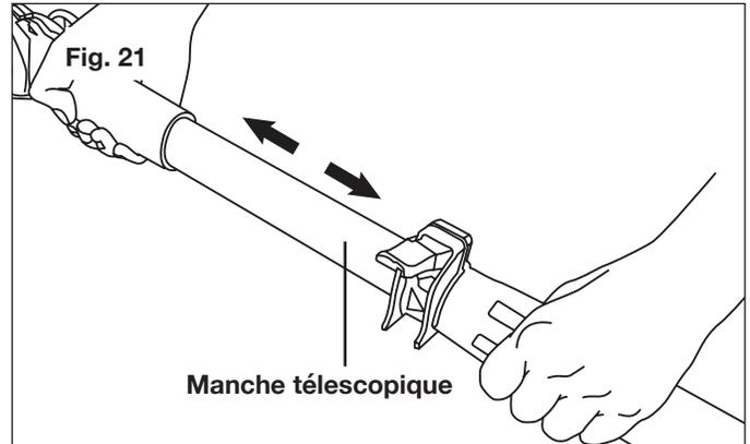
4. Verrouillez le manche à la longueur voulue en fermant la came de serrage (Fig. 22) et assurez-vous que le manche est bien attaché. Si le manche se rallonge ou se raccourcit quand la came de serrage est fermée, l'écrou doit être resserré.
