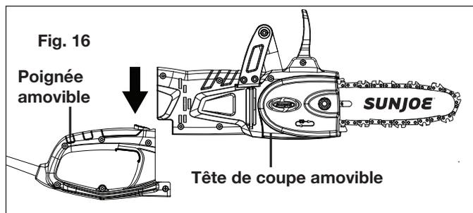
**⚠ AVERTISSEMENT!** Avant d'utiliser la scie à chaîne, toujours s'assurer que le verrou de poignée est verrouillé.
