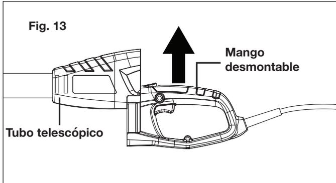
**⚠ ¡ADVERTENCIA!** Asegúrese de que tanto la traba de cabezal de corte como la traba de mango estén trabadas de forma segura antes de usar la motosierra eléctrica en el modo de motosierra de altura.
