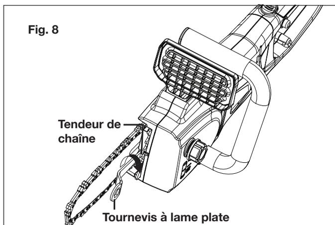
8. Remplacez la coiffe arrière de chaîne/pignon. Serrez l'écrou de coiffe arrière, mais laissez le guide-chaîne se déplacer librement pour le réglage de la tension.
