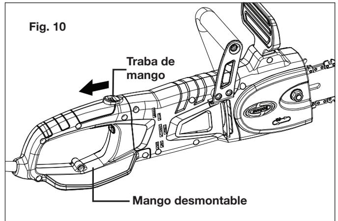
2. Mientras jala la traba de mango, use la otra mano para sujetar el mango frontal y deslizar el cabezal de corte desmontable para retirarlo (Fig. 11).
