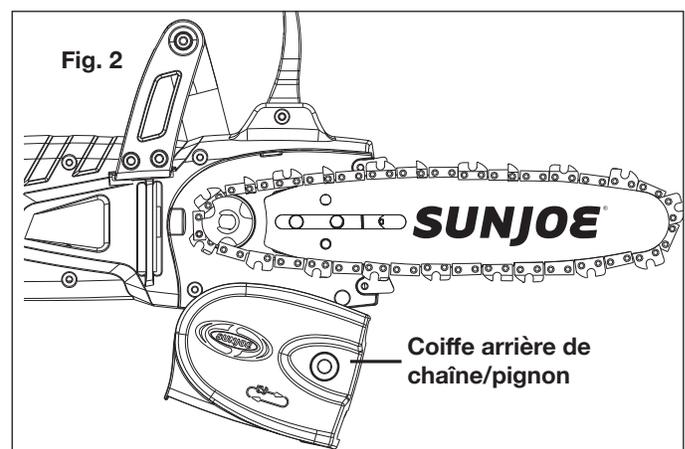
2. Retirez le guide-chaîne et la chaîne de la surface de fixation (Fig. 3).
