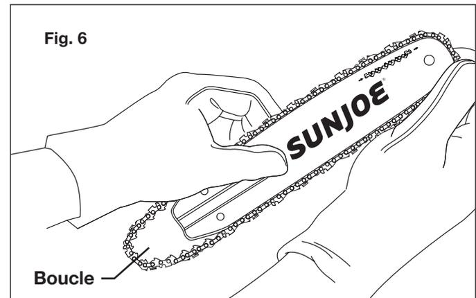
6. Maintenez la chaîne en position sur le guide-chaîne et enroulez la boucle autour du pignon. Placez le guide-chaîne pour qu'il repose bien contre la surface de fixation, pour que les goujons du guide-chaîne soient dans la longue fente du guide-chaîne et pour que la goupille de réglage soit dans le trou de la goupille de tension de chaîne (Fig. 7).
