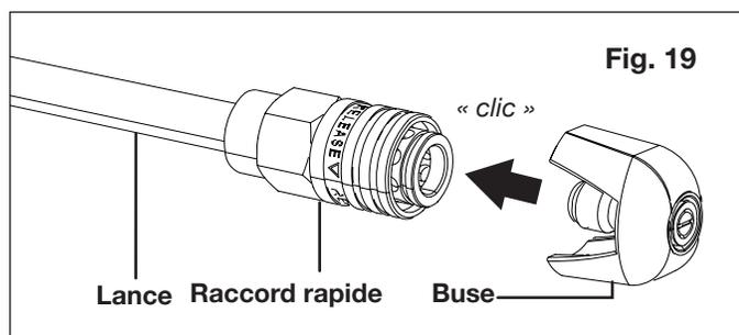
Pour débrancher la buse de la lance une fois que le nettoyage est achevé :
