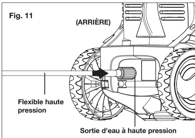
**⚠ AVERTISSEMENT!** Maintenir le flexible à l'écart des objets tranchants. Les flexibles qui éclatent peuvent blesser. Examiner régulièrement les flexibles et les remplacer s'ils sont endommagés. Ne pas essayer de réparer un flexible endommagé.
