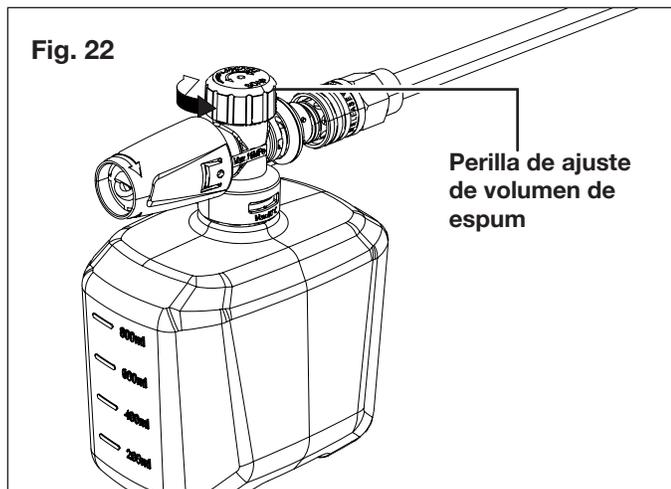
5. Aplique el detergente desde abajo hacia arriba en la superficie seca a ser limpiada. Aplicar detergente de esta forma disolverá la suciedad de forma más eficiente.
