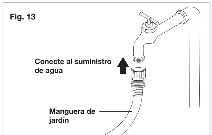
**⚠ ¡ADVERTENCIA!** La temperatura del agua de entrada no debe exceder los 104 °F (40 °C). La presión del suministro de agua no debe exceder 0.7 MPa.
