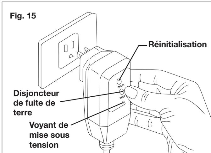
**REMARQUE :** il se peut que le disjoncteur de fuite de terre nécessite d'être d'abord branché dans la prise secteur. Appuyez sur le bouton « Reset » (Réinitialisation) jusqu'à ce que le voyant de mise sous tension sur le disjoncteur de fuite de terre s'allume.
