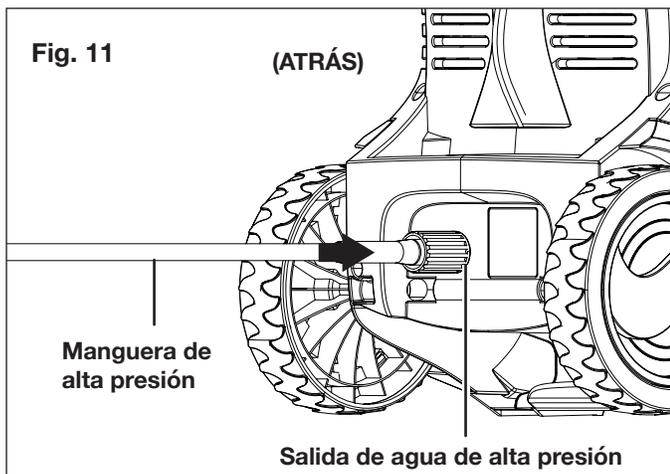
**⚠ ¡ADVERTENCIA!** Mantenga la manguera alejada de objetos afilados. Una manguera que reviente puede causar lesiones. Examine las mangueras regularmente y reemplácelas si están dañadas. No intente reparar una manguera dañada.
