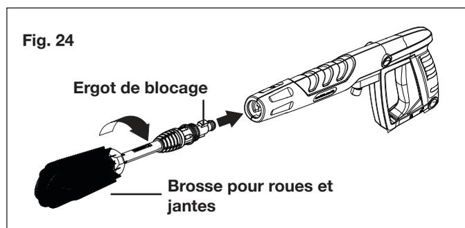
3. Une fois l'alignement réalisé, poussez la brosse pour roues et jantes dans le pistolet et tournez-la dans le sens antihoraire afin qu'elle se mette en place et se verrouille.
