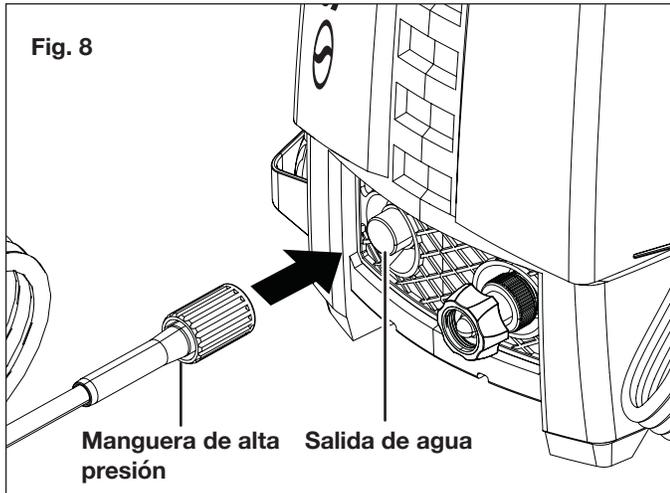
**⚠ ¡ADVERTENCIA!** Mantenga la manguera alejada de objetos afilados. Una manguera que revienta puede causar lesiones personales. Examine las mangueras regularmente y reemplácelas si están dañadas. No intente reparar una manguera dañada.
