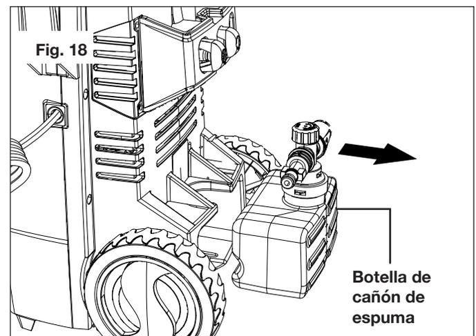
2. Retire la tapa. Llene la botella o mezcle según lo recomendado por las instrucciones del detergente (Fig. 19), y vuelva a colocar de forma segura la tapa en su lugar. Vuélvala a colocar en la unidad.
