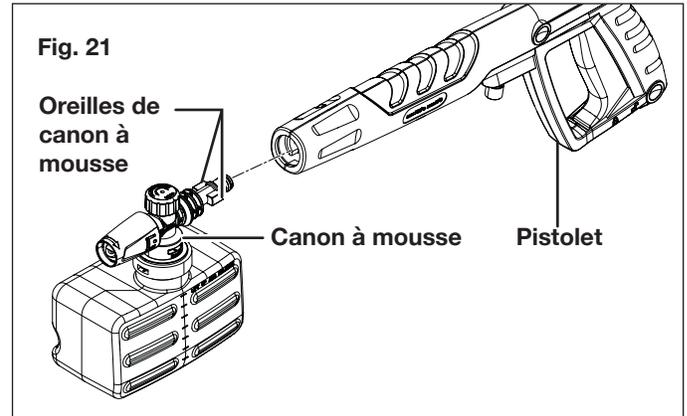
5. Mettez en marche le nettoyeur haute pression. Pressez la gâchette pour utiliser la machine. Le détergent liquide se mélangera automatiquement à l'eau et sera pulvérisé en passant par la buse.
