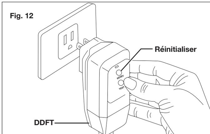
**REMARQUE :** il se peut que le DDFT nécessite d'être d'abord branché dans la prise électrique. Appuyez sur le bouton « Reset » (Réinitialiser) jusqu'à ce que le voyant de mise sous tension sur le DDFT s'allume lorsque la machine est branchée.
