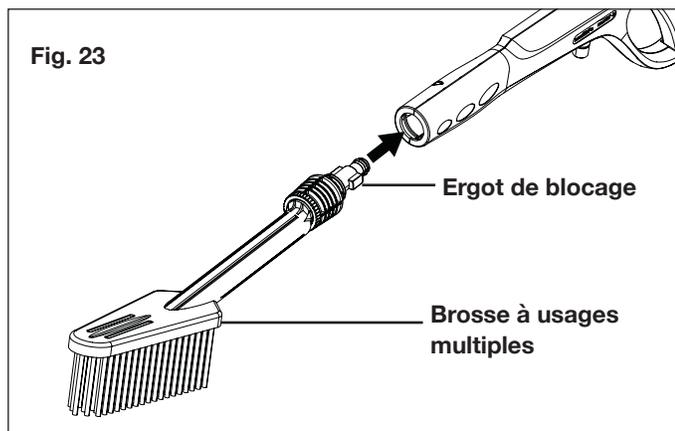
3. Une fois l'alignement réalisé, poussez la brosse à usages multiples dans le pistolet et tournez-la dans le sens antihoraire pour qu'elle se mette en place et se verrouille.
