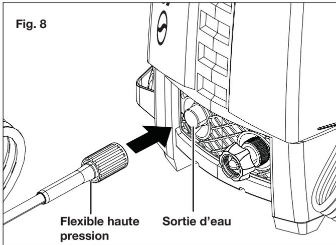
**⚠️ AVERTISSEMENT!** Maintenir le flexible haute pression à l'écart des objets tranchants. Un tuyau souple qui éclate peut causer des blessures. Examiner régulièrement les tuyaux souples et les remplacer s'ils sont endommagés. Ne pas essayer de réparer un tuyau souple endommagé.
