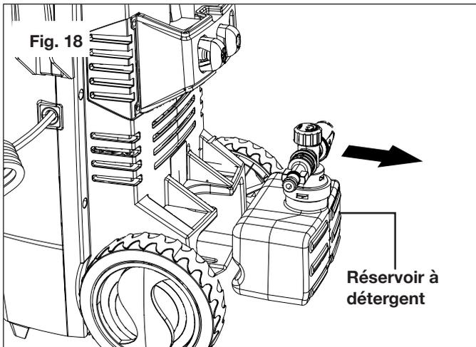
2. Retirer le bouchon. Remplissez le réservoir d'un détergent ou d'un mélange selon les instructions du fabricant du détergent (Fig. 19) et remettez le bouchon en place. Remplacez le réservoir sur la machine.
