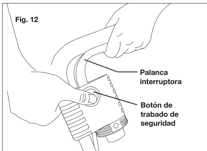
4. Una vez que la máquina se encienda, suelte el botón de trabado de seguridad y proceda con la operación, bajando cuidadosamente la podadora a la posición de corte (Fig. 13).
