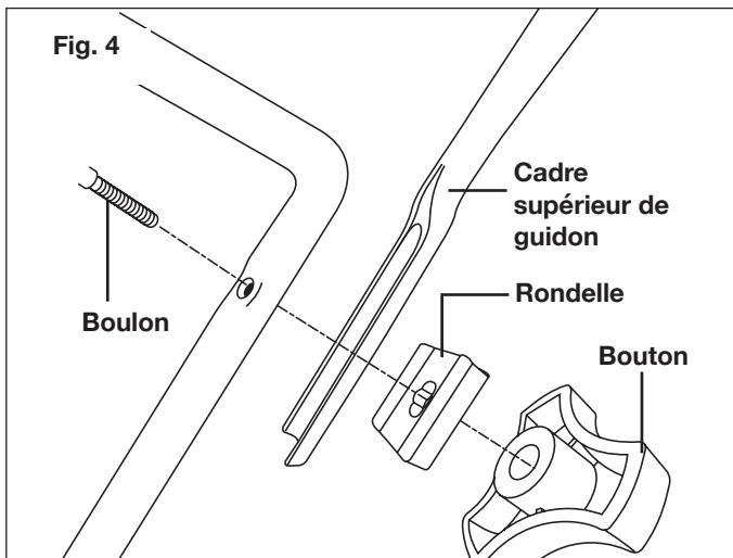
**REMARQUE :** deux trous sont pratiqués de chaque côté du cadre supérieur de guidon; toutefois, un seul trou est nécessaire de chaque côté pour l'attacher au cadre inférieur de guidon (Fig. 5). Choisissez simplement votre hauteur préférée et attachez les deux cadres comme l'indique la Fig. 4.
