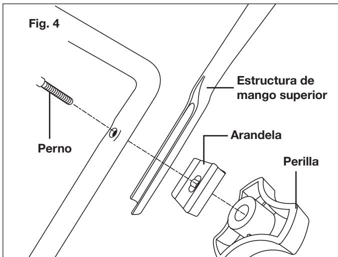
**NOTA:** la estructura de mango superior viene con dos orificios en cada lado (Fig. 3); sin embargo, solo se necesita un orificio en cada lado para asegurar la estructura de mango inferior. Simplemente seleccione su altura preferida, y asegure tal como se muestra (Fig. 5).
