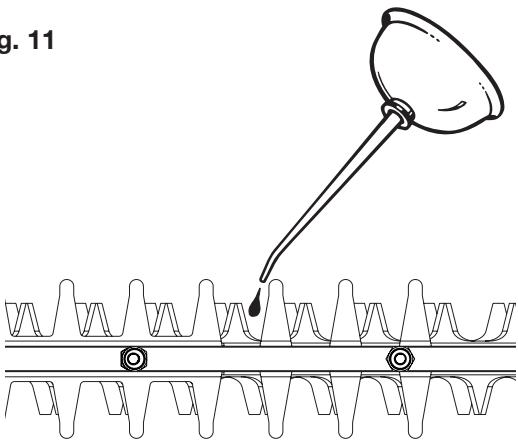
Si va a usar la bordeadora de arbustos por un periodo prolongado, se recomienda detener el trabajo de forma intermitente para re-aceitar las cuchillas.
