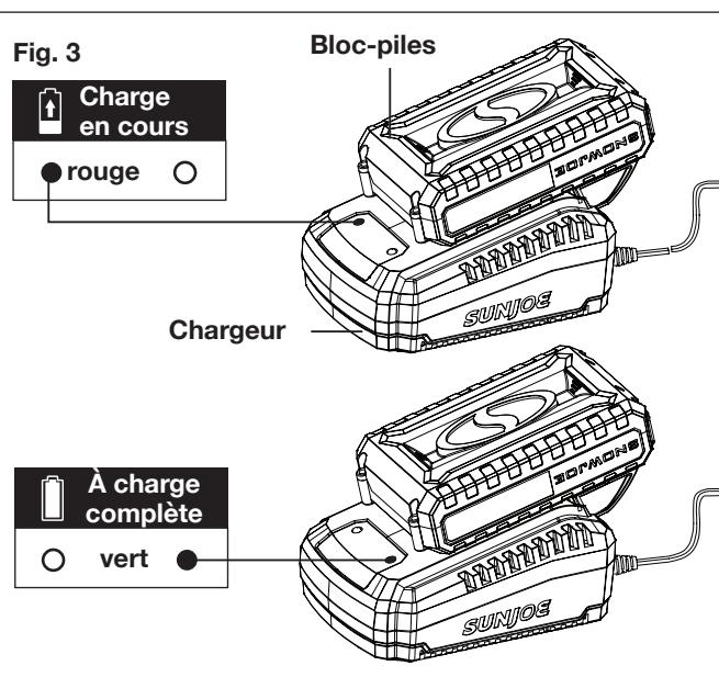
4. Lorsque le témoin du chargeur passe au vert, la batterie est à charge complète (Fig. 3).
