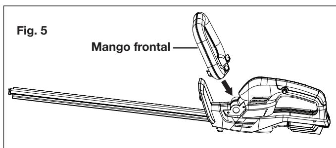
2. Asegure el mango frontal en la unidad con los cuatro (4) tornillos de mango frontal (Fig. 6). Cuando los tornillos estén completamente asegurados, su bordeadora de arbustos está lista para usarse.
