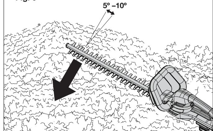
3. Para realizar un corte vertical, empiece podando en la parte inferior, y haga una acción de barrido hacia arriba para un corte parejo. Mueva las cuchillas en vaivén, en un arco hacia los exteriores del arbusto de manera que los cortes sean barridos hacia el suelo (Fig. 10).
