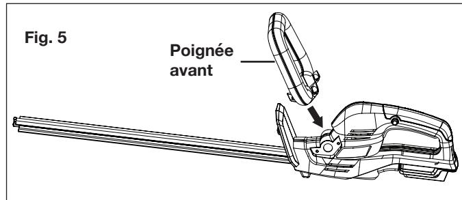
2. Attachez la poignée avant sur l'outil à l'aide des quatre vis prévues à cet effet (Fig. 6). Lorsque les vis sont bien vissées, votre taille-haie est prêt à être utilisé.
