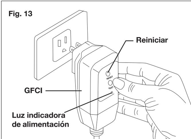
**NOTA:** es posible que el GFCI tenga que reiniciarse al enchufarlo por primera vez al tomacorriente. Presione el botón "Reset" ("reinicio") hasta que la luz indicadora de alimentación del GFCI se encienda.
