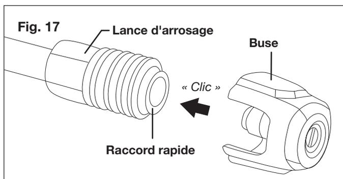
Pour débrancher la buse de la lance d'arrosage une fois que le nettoyage est achevé :
