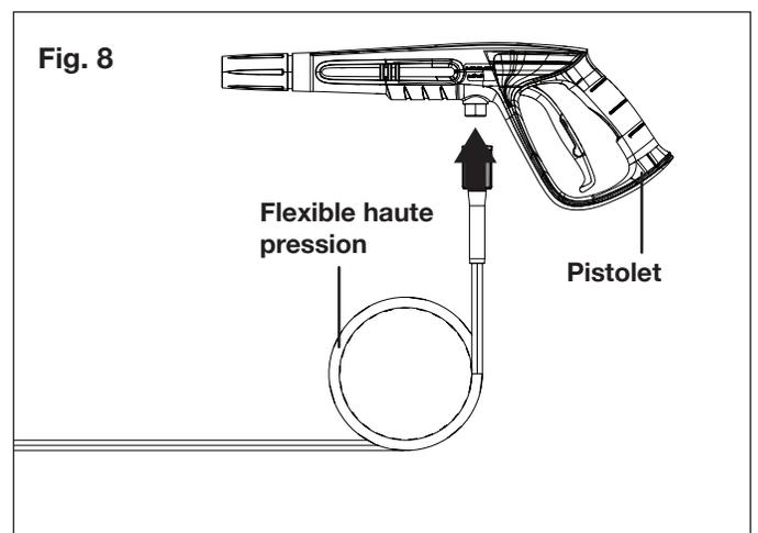
**⚠️ AVERTISSEMENT!** Maintenir le flexible à l'écart des objets tranchants. Un flexible qui éclate peut être à l'origine de blessures. Examiner régulièrement le flexible et le remplacer s'il est endommagé. Ne pas essayer de réparer un flexible endommagé.
