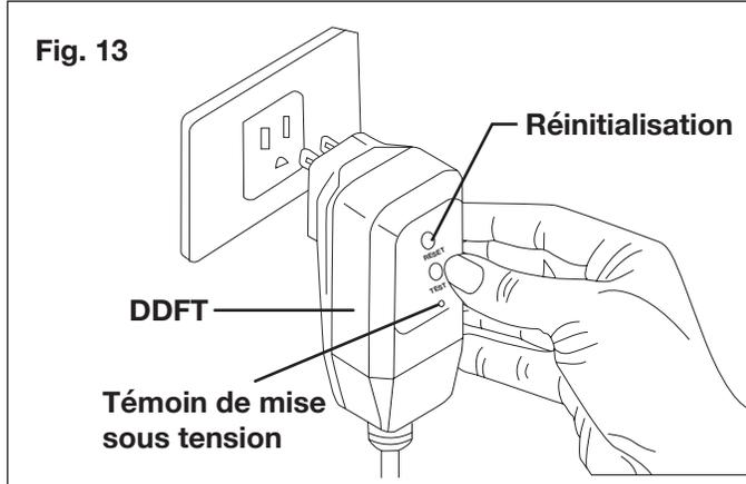
**REMARQUE :** il se peut que le DDFT nécessite d'être d'abord branché dans la prise électrique. Appuyez sur le bouton « Reset » (Réinitialisation) jusqu'à ce que le voyant de mise sous tension sur le DDFT s'allume.
