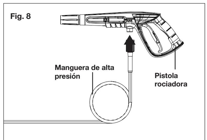
**⚠ ¡ADVERTENCIA!** Mantenga la manguera alejada de objetos afilados. Una manguera que revienta puede causar lesiones personales. Examine las mangueras regularmente y reemplácelas si están dañadas. No intente reparar una manguera dañada.
