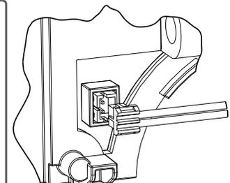
**INSERT SOLENOID CONNECTOR HERE**
