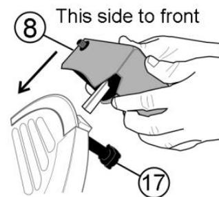
FIG 3. INSTALLING THE SHARPENER BOX
