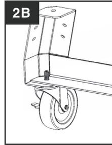
2. Passez les fils des roulettes par le bas de coin. Placer une traverse longue à l'intérieur du coin, en alignant le trou avec les filetages des roulettes et mettre passe à travers.
