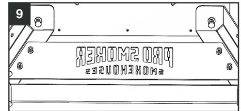
10. Une fois le support installé sans serrer, fixez entièrement chaque coin au fumeur avec clé 9/16". Fixez fermement le roulettes. Enfin, attachez le visage plaques avec la clé 7/16".
