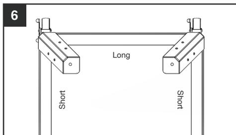
5. Placez une traverse courte à l'intérieur du coin, à 90° de la pièce longue, aligner le trou avec les filetages des roulettes et passer à travers. Mettez une rondelle fendue de 3/8" sur les fils des roulettes et fixez-les sans serrer Écrou de 3/8" sur la roulette.
