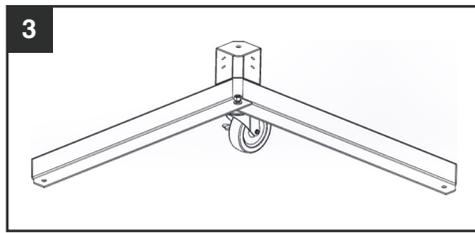
3. Placez une traverse courte à l'intérieur de coin, à 90° de la pièce longue, aligner le trou avec la roulette fils et passer les fils. Mettez une rondelle fendue de 3/8" sur la roulette fils et fixez-les sans serrer 3/8" l'écrou sur la roulette.
