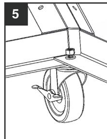
4. Continuez à vous appuyer sur l'assemblage récent en plaçant un autre coin à l'extérieur l'extrémité de la traverse longue et mettre une roulette à travers les trous alignés.
