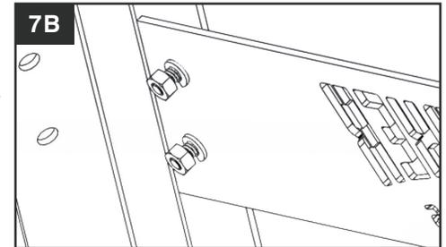
9. Installez le support sur le fumeur, serrez sans serrer (4) boulons 3/8" avec (4) Rondelles fendues de 3/8" dans les trous supérieurs des coins au bas du fumeur.
