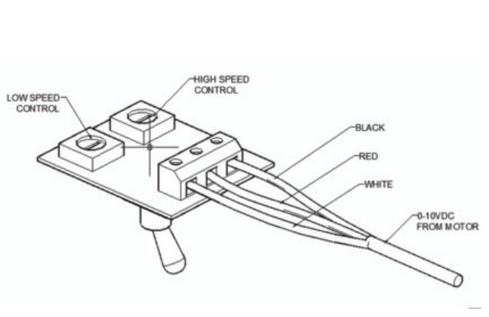
0-10V REMOTE POT DOES NOT DISCONNECT POWER FROM MOTOR ONLY SETS MOTOR TO ZERO RPM
