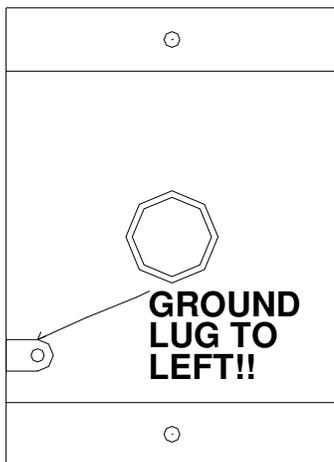
**MOUNT THE 75LC ENCLOSURE WITH THE GROUND LUG TO THE LEFT SO THAT THE BATTERY DOES NOT CONTACT THE GROUND LUG WHEN THE ALARM IS INSTALLED**
