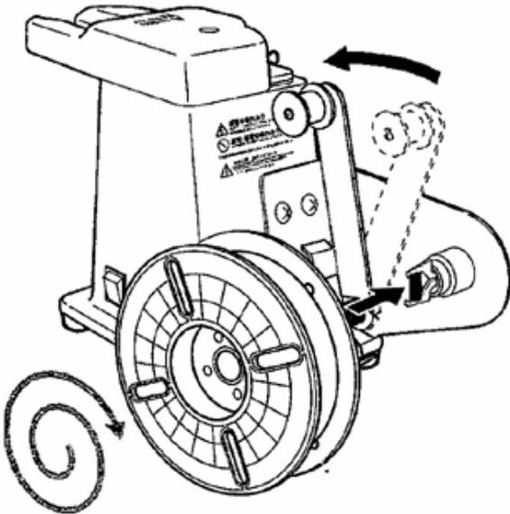
LOCATE AND FIND THE RIBBON SPOOL BRAKE ARM. PUSH THE RIBBON SPOOL BRAKE ARM TOWARDS THE FRONT OF THE MACHINE AND PUT THE SPOOL ONTO THE RIBBON SPOOL MANDREL SO THAT WHEN PULLED THE LEADING END OF THE RIBBON IS GOING TOWARDS THE RIBBON SPOOL BRAKE ROLLER. SEE DIAGRAM.
