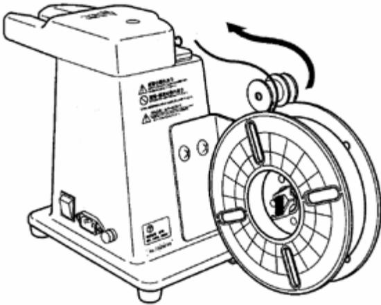
UNWIND THE RIBBON FROM THE SPOOL; BRING IT AROUND THE RIBBON SPOOL BRAKE ROLLER AND TOWARDS THE FRONT OF THE MACHINE. **PLEASE NOTE THAT WHEN BRINGING THE RIBBON AROUND THE RIBBON SPOOL BRAKE ROLLER THAT IT IS IN DIRECT CONTACT WITH THE ROLLER AND UNDER THE METAL BAR THAT GOES ACROSS THE TOP OF THE ROLLER.**
