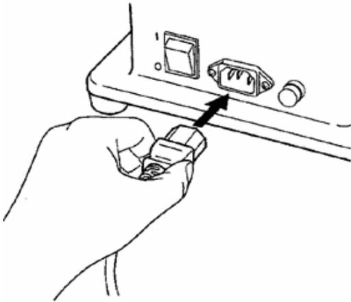
ATTACH THE POWER CORD TO THE IEC OUTLET LOCATED ON THE RIGHT SIDE OF THE MACHINE. DO NOT PLUG POWER CORD INTO POWER OUTLET YET.
