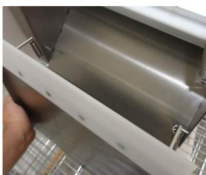
El raspador Nº 2 queda encima del rodillo inferior y está colocado junto a la bandeja de descarga como una sola pieza. Para remover la bandeja, alcance bajo la bandeja de descarga y desconecte los resortes del raspador de sus clavitos. Suba la bandeja hacia la máquina y el raspador se
