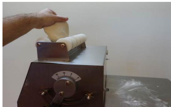
**\*\* Si la masa no se desliza fácilmente en las bandejas de descarga, espolvoréelas con harina. \*\***
