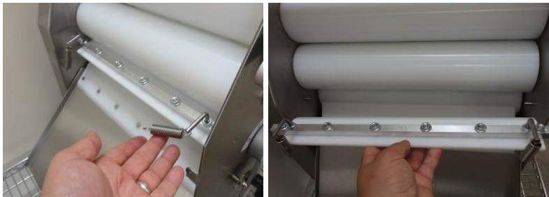
El raspador Nº 1 queda abajo del rodillo del medio y se sujet a los clavitos de raspador en la pared interna de la máquina. El borde biselado apunta entre el rodillo del medio y el rodillo inferior.
