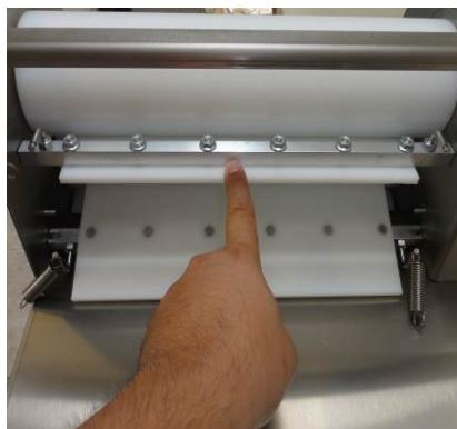
El Nº 3 y el Nº 4 se conectan el uno al otro. El raspador Nº 4 queda sobre los clavitos del raspador y el borde biselado empuja hacia el rodillo superior. Los resortes del raspador Nº 3 se conectan con el raspador Nº 4 forzando las ranuras del eje del rodillo dentro de los clavitos del raspador. El borde biselado empuja hacia el rodillo
