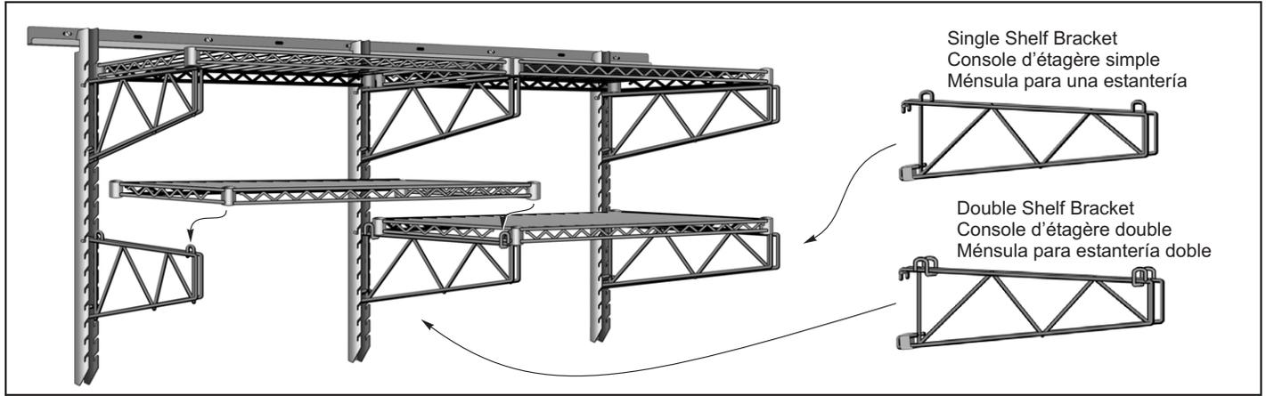
**Attaching Grids to Uprights / Fixation des grilles aux montants / Instalación de rejillas en los soportes verticales**
