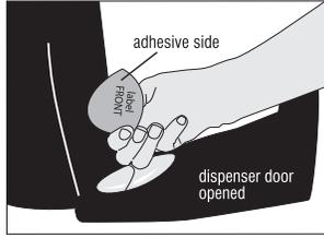
2. Open dispenser. Place label sticky side down on INSIDE of clear oval window. 2. Ouvrir la distributrice. Poser l'étiquette, le côté adhésif vers le bas, sur L'INTÉRIEUR de la fenêtre ovale transparente. 2. Abra el dispensador. Coloque la etiqueta, el lado pegajoso hacia abajo, sobre el INTERIOR de la ventana oval transparente.
