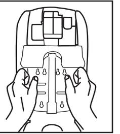
4. Abra el dispensador, presionando la traba hacia arriba. La traba está situada en el borde inferior y posterior del dispensador del medio. ATENCIÓN: Consulte la "Opción para trabar con llave" si desea cambiar su dispensador al sistema de llave. Mientras presiona la traba, abra el dispensador apoyando su otra mano en la parte de arriba y guiando la cubierta del frente hacia adelante. Desde el interior del dispensador, presione sobre el área recién adherida.
