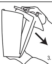
3. Abra el dispensador, presionando la traba hacia arriba. La traba está en el borde inferior posterior del dispensador del medio. ATENCIÓN: Consulte la "Opción para trabar con llave" si desea cambiar su dispensador al sistema de llave. Mientras presiona la traba, abra el dispensador apoyando su otra mano en la parte de arriba y guiando la cubierta del frente hacia adelante.
