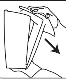
4. Ouvrir la distributrice en pressant le loquet de déblocage vers le haut. Le loquet se trouve sur le bord inférieur de la partie arrière de la distributrice, au centre. NOTA : Voir l'option " Option de verrouillage à clé " si vous désirez convertir la distributrice à un système à clé. Tout en pressant le loquet de déblocage d'une main, ouvrir la distributrice en plaçant l'autre main sur le dessus et en dirigeant le couvercle vers l'avant.
