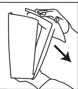
de la partie arrière de la distributrice, au centre. Tout en pressant le loquet de déblocage d'une main, ouvrir la distributrice en plaçant l'autre main sur le dessus et en dirigeant le couvercle vers l'avant.
