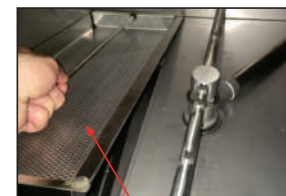
Limpieza del cedazo
