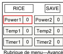
a. Tournez le bouton de commande pour placer POWER1 ou TEMP1 en surbrillance en rouge, en fonction de la méthode de cuisson. Appuyez sur le bouton de commande pour sélectionner la méthode de commande de cuisson.
