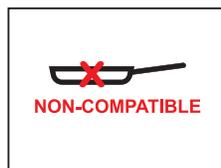
**NOTA:** Les cuisinières à induction détectent automatiquement les récipients compatibles. Si un récipient non compatible est posé sur l'appareil, une icône en forme de poêle avec le message « non compatible » s'affiche sur l'écran, et l'appareil ne fonctionnera pas.
