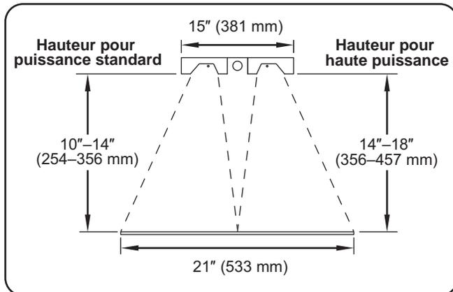
Hauteur d'élément recommandée pour les modèles doubles GRA-D, GRAH-D, GRAL-D et GRAHL-D de toute longueur avec une entretoise de 3 po (76 mm).
