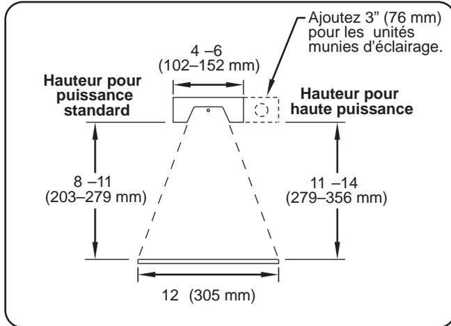
Hauteur d'élément recommandée pour les modèles GR, GRA, GRH, GRN, GRAH, GRAL, GRNH, et GRAHL de toute longueur (à l'exclusion des modèles doubles).
