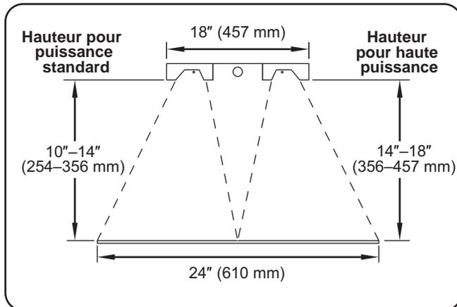
Hauteur d'élément recommandée pour les modèles doubles GRA-D, GRAH-D, GRAL-D et GRAHL-D de toute longueur avec une entretoise de 6 po (152 mm).
