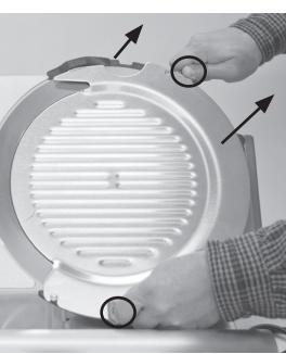
**6.** Junto al anillo protector, encontrará un deflector de lonchas, flexible y desmontable. En el centro del anillo protector encontrará una lengüeta de bloqueo. Con cuidado, tire la parte inferior de la lengüeta hacia afuera con dos dedos mientras fija la parte superior de la lengüeta en su lugar con el pulgar. Levante el deflector de lonchas entre la cuchilla y el anillo protector.
