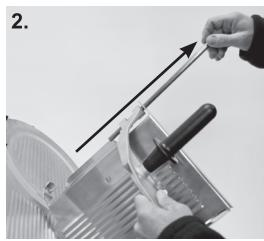
**3.** Quite el carro deslizante de alimentos aflojando la perilla de desenganche del carro deslizante que lo sujeta al brazo del carro.
