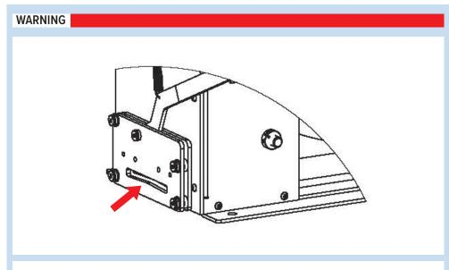
**WARNING:** GUILLOTINE BLADE INSIDE CUTTER IS SHARP. DO NOT PLACE FINGERS UNDER THE GUILLOTINE BLADE.
