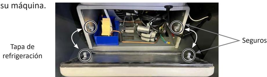
Se puede acceder al compresor y al circuito del relé, al motor del ventilador del condensador y a la bandeja de drenaje de la misma manera quitando la cubierta frontal. La refrigeración debe desconectarse y el módulo debe deslizarse completamente hacia afuera para poder acceder a estos componentes.
