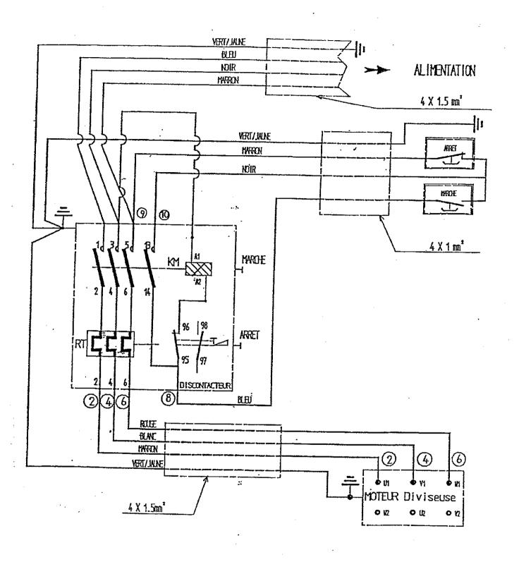
1.5 Kw 208V - 60Hz - 6.4A 220V - 50Hz - 6.0A
