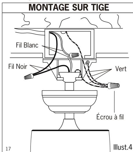
**N.B.:** Lorsque les fils sont branchés, pousser soigneusement les fils et les écrous à fils dans la boîte électrique en vous assurant que les fils ne sont pas gênés par l'hémisphère ou la tige lorsque vous positionnez la ferrure de montage (pour installation avec tige seulement).
