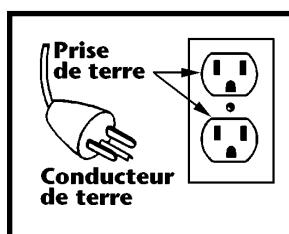
Cet appareil est destiné à un circuit de 120V et est muni d'une fiche de mise à la terre semblable à celle illustrée par le croquis A de la figure "A". S'assurer que l'appareil est branché à une prise de courant ayant la même configuration que la fiche. Aucun adaptateur ne devrait être utilisé avec cet appareil.
