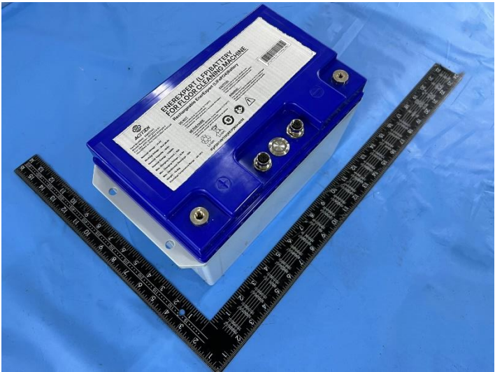
Battery/电池（ZP22314-01 25,6V 50Ah 1280Wh）
