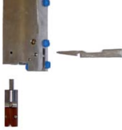
Abbildung 12: Demontage Führung und Hebel
