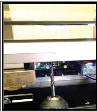
4 Drill AMB mounting holes
