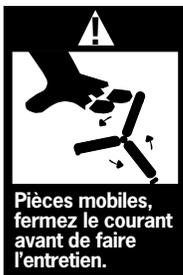
**MISE EN GARDE: LE GRILLAGE DE CE VENTILATEUR EST À L'INTÉRIEUR. VOUS DEVEZ DONC L'INSTALLER À AU MOINS 2.5 MÈTRES DU SOL AFIN D'ÉVITER TOUT CONTACT ACCIDENTEL AVEC LA PALE.**
