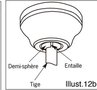
**N.B.:** Lorsque vous installez un ventilateur sur un plafond en pente, assurez-vous que l'entaille sur la ferrure soit face à la pente du plafond. Dépendant de l'angle de cette pente, une tige plus longue peut être requise afin d'empêcher les pales de cogner le plafond.
