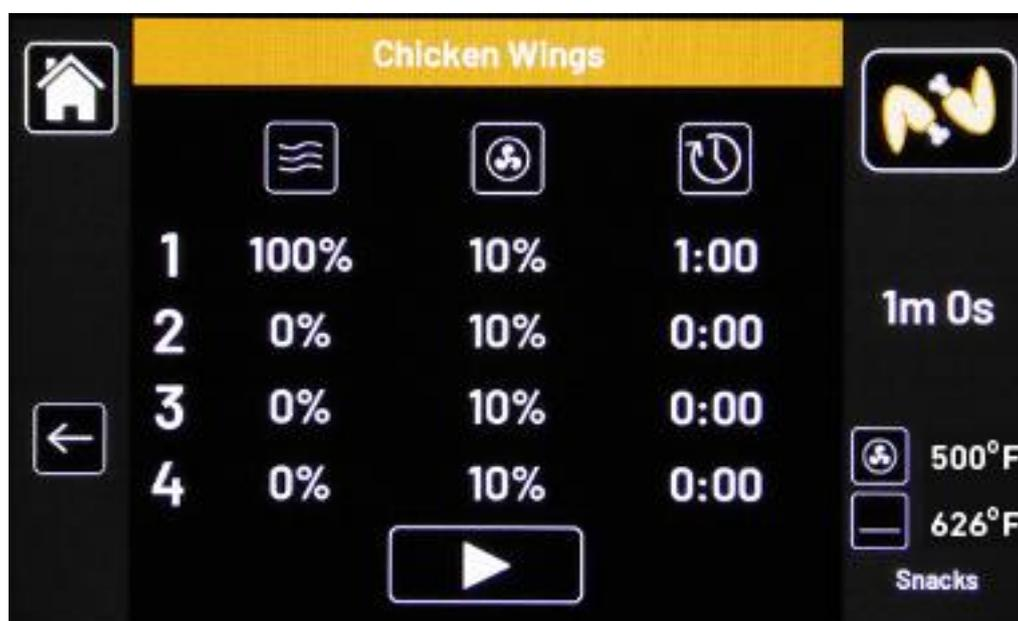
L'écran de modification des recettes comprend 4 rangées d'étapes de cuisson (toutes ne devront pas être utilisées pour la plupart des recettes), avec 3 colonnes pour définir la puissance du four à micro-ondes, la vitesse du ventilateur et le temps.
