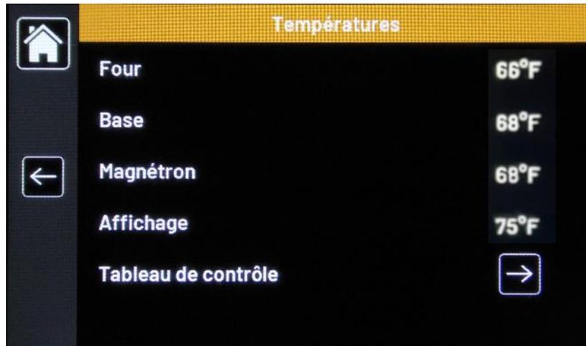
Cet écran est utilisé par les techniciens d'entretien pour vérifier la température des différents composants du four. Si une température est trop élevée, elle est colorée en rouge et peut être due à un manque de circulation d'air dans le four.
