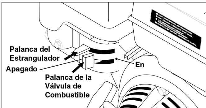
**PASO 6:** Deslice la palanca de combustible a la posición ON (ENCENDIDO). (Cuando el motor no esté en uso, deje la válvula de combustible en la posición "OFF (APAGADO)".)
