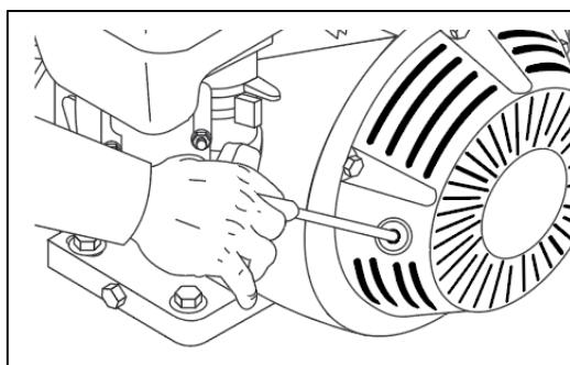
**PASO 9:** Tire de la empuñadura de arranque. Si el motor no arranca después de 2 tirones, apriete el gatillo de la pistola para liberar la presión y repita el paso. Retorne el cable de arranque con cuidado. Una vez que el motor se calienta lo suficiente como para funcionar sin problemas, ponga el estrangulador en posición de marcha y el acelerador en posición rápida.
