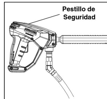
**ADVERTENCIA! No sustituya nunca las boquillas sin accionar el pestillo de seguridad del gatillo de la pistola de pulverización.**
