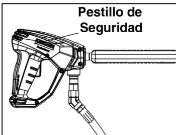
**PASO 5:** Enganche el bloqueo de seguridad de la pistola de pulverización.
