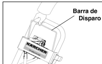
**PASO 6:** Tire de la barra del gatillo para drenar el agua del brazo giratorio del limpiador de superficies y del brazo rociador.
