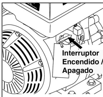
**PASO 8:** Coloque el interruptor del motor en la posición RUN (EJECUTAR).
