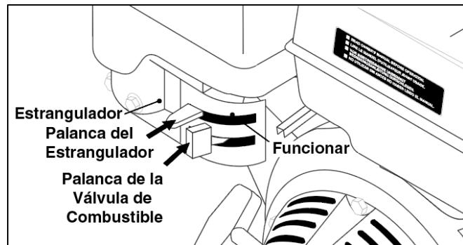
**PASO 7:** Mueva la palanca del estrangulador a la posición de estrangulamiento (consulte la imagen siguiente). Con el motor caliente, deje la palanca del estrangulador en la posición de marcha.
