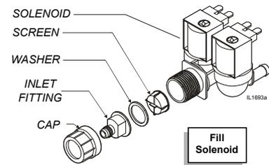
Fig. 16 Fill Solenoid
