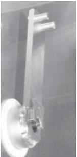
ÉTAPE 2 : Placez l'arbre de rotor sur l'encoche supérieure du palier d'appui sur le côté de non-entraînement du four (figure 5).
